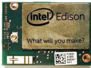
Fig. 3. The Intel Edison module
